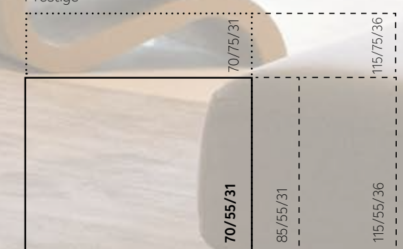
Dimensions de la vitre des foyers à trois côtés avec brûleur Prestige
